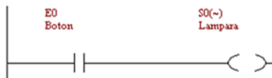
Figura 8. 1 Escalón resultante de la tabla 8.2, con la entrada Eo desactivada
