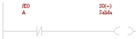
Figura 15. 14 Función Lógica Inversora (NOT) con las entrada A en “1”.
