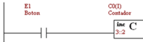
Figura 10. 8 Nuevamente se suelta el botón para preparar el siguiente conteo
