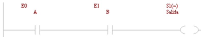
Figura 15. 5 Función Lógica AND (Y) con las entradas A y B en “0”.
