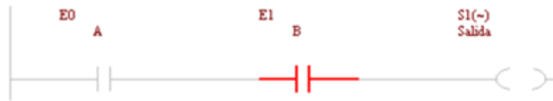
Figura 15. 6 Función Lógica AND (Y) con entrada A en “0” y B en “1”.
