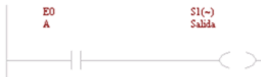
Figura 15. 15 Función Lógica NO Inversora con las entrada A en “0”.
