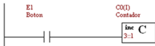
Figura 10. 6 Se suelta el botón para preparar el siguiente conteo
