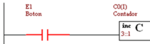
Figura 10. 5 Al presionar el botón de la entrada E1 se incrementa en 1 el conteo
