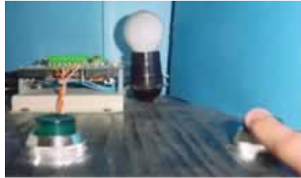
Figura 9. 4 Botón de apagado que desactiva la salida memorizada
