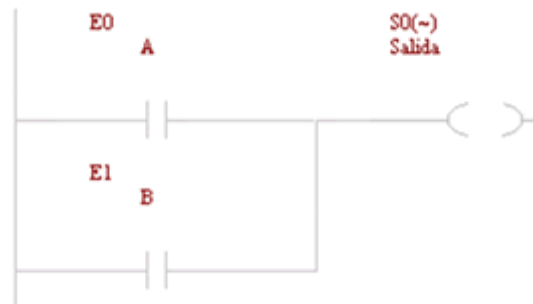
Figura 15. 9 Función Lógica OR (O) con las entradas A y B en “0”.
