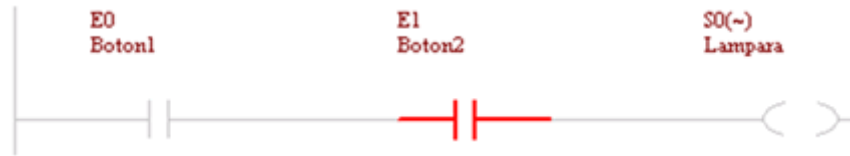
Figura 8. 7 Escalón resultante de la tabla 7.3, con la entrada E_0 desactivada y E_1 activada
