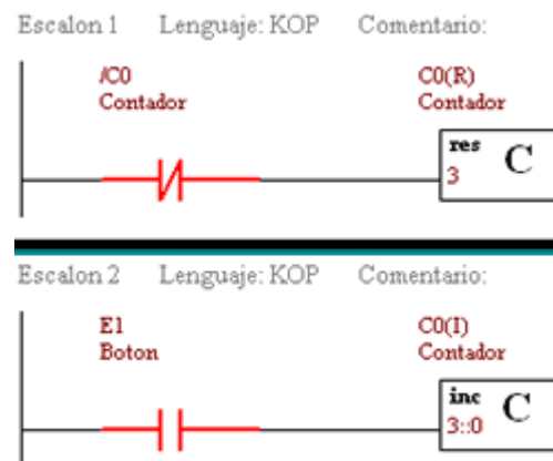
Figura 10. 12 Restablecimiento a cero del contador por un contacto propio
