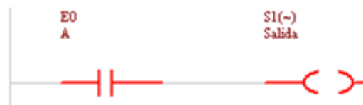
Figura 15. 16 Función Lógica NO Inversora con las entrada A en “1”.
