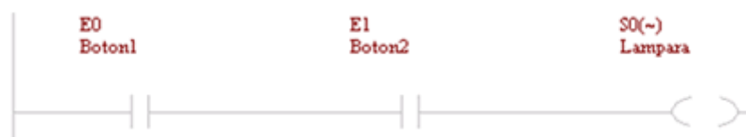
Figura 8. 5 Escalón resultante de la tabla 7.3, con las entradas E 0 y E 1 desactivadas
