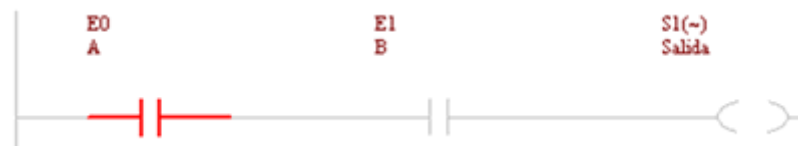
Figura 15. 7 Función Lógica AND (Y) con entrada A en “1” y B en “0”.
