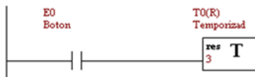
Figura 9. 5 Activación de un temporizador
