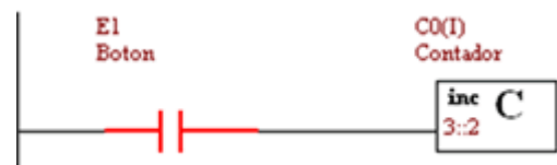
10. 7 Nuevamente se presiona el botón de la entrada E1 para incrementar en 1 el conteo
