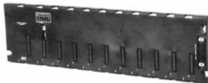
Figura 3. 11 Ejemplo de base donde se insertan los módulos de entrada o salida y la UCP.
