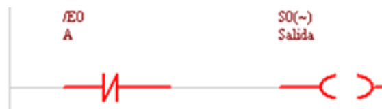
Figura 15. 13 Función Lógica Inversora (NOT) con las entrada A en “0”.
